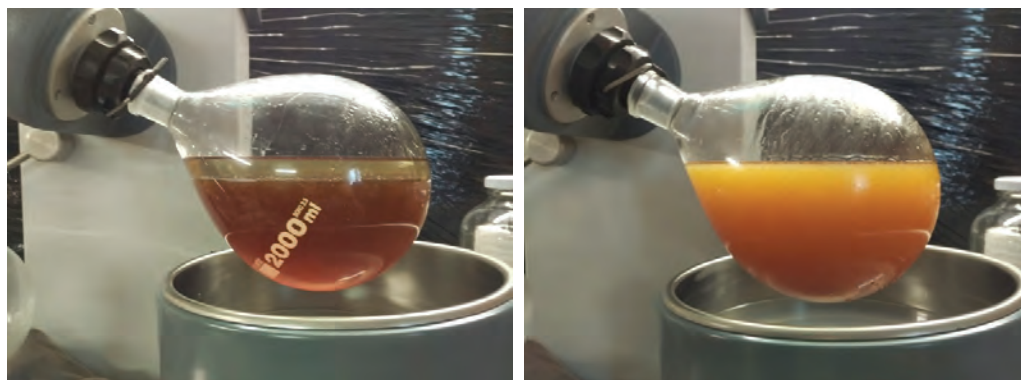
Rys. 4. Widok mieszaniny przed i po procesie homogenizacji (po prawej stronie mieszanina jednorodna)
