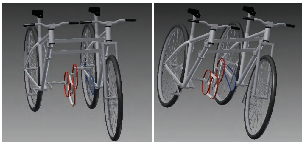
Rys. 4. Podstawowy model projektowanej konstrukcji (po lewej podczas jazdy wprost, a po prawej podczas skrętu)
