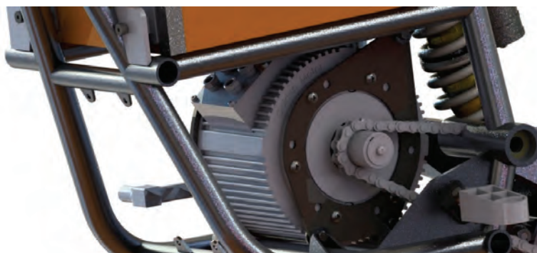
Rys. 2. Mocowania silnika wraz z komponentami w ramie
