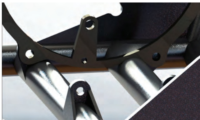
Rys. 3. Przewężenie tylnego mocowania
