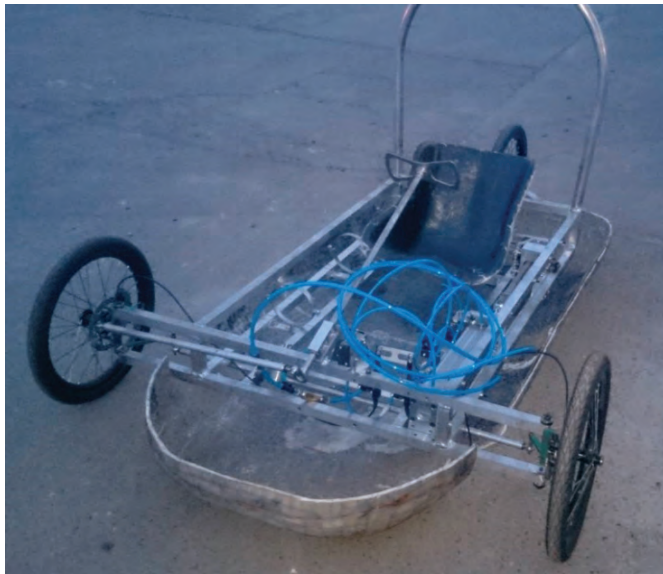
Rys. 3. Poglądowe zdjęcie przedstawiające układ kierowniczy i ramę pojazdu
