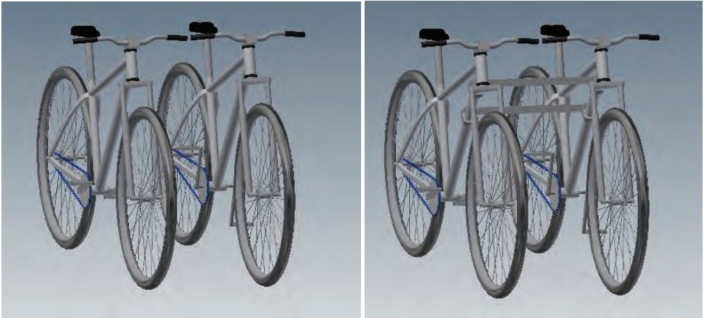
Rys. 2. Równoległe zestawienie rowerów (po lewej) i wahaczowe połączenie (po prawej)
